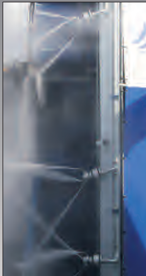
Lavaggio alta pressione con testate rotanti High pressure cleaning with rotating heads
