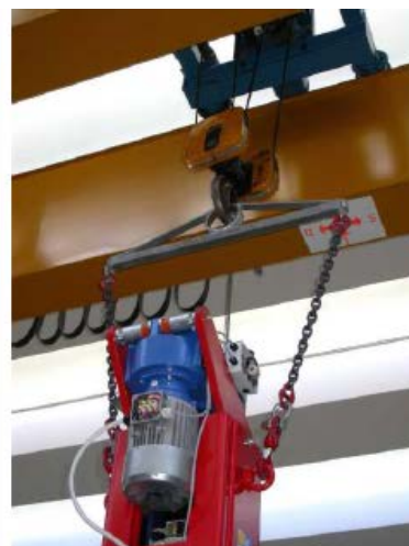
*Снимки, показващи "куки" за повдигане и придвижване на подемяка с кран.
