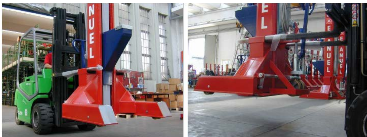
*Снимки, показващи профилите за повдигане и придвижване на подемяка с помощта на мотокар.
