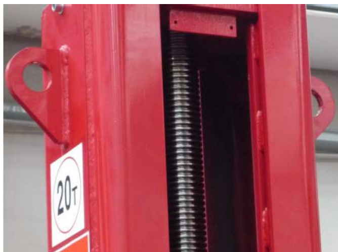
*Снимки, показващи "куки" за повдигане и придвижване на подемяка с кран.
