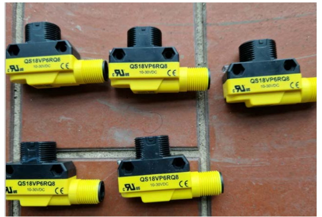
10 бр. сензори за определяне дължината на автомобила
