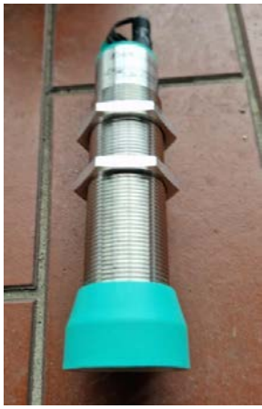
3 бр. сензори за определяне широчината на автомобила
